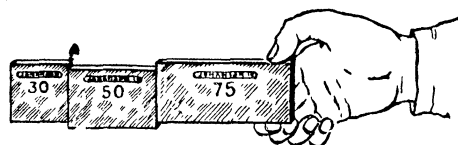
Рис. 126. При соприкосновении плиток Иогансона проявляется действие сил молекулярного притяжения.
