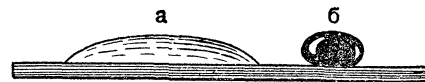
Рис. 152. а — жидкость, смачивающая твёрдое тело, растекается по его поверхности; б — жидкость, не смачивающая твёрдое тело; не растекается.
