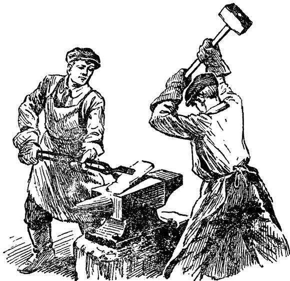
Рис. 100. Масса наковальни значительно больше массы молота.
