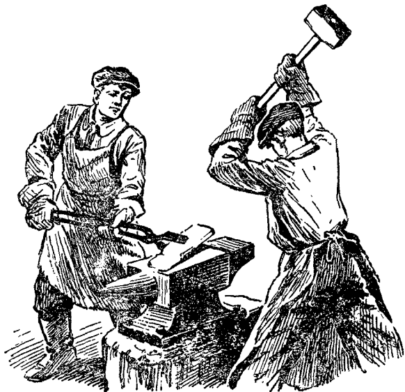
Рис. 100. Масса наковальни значительно больше массы молота.
