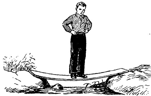
Рис. 56. Вес человека уравнивается силой, действующей на него со стороны деформированной доски.
